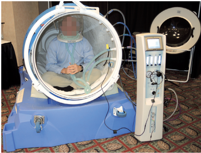
Figura 2. Prototipo de cámara hiperbárica monoplasma flexible, plegable y transportable, de material sintético de alta resistencia. Está homologada para trabajo a 3ata, pero en las pruebas de laboratorio ha resistido más de 12ata. (Fotografía del autor).
